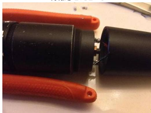
図6 トランスを除去後、再び半田付けを行う
